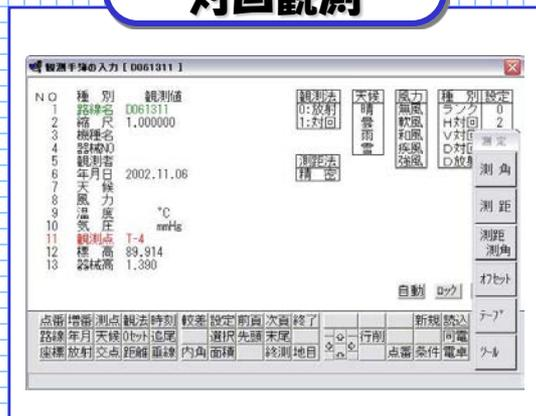
電子野帳機能をサポートいたしました。2対回までの観測サポートと閉合、結合トラバース計算を合わせてサポートいたしました。手簿、計算書の印刷はもちろんのこと、各社電子野帳の形式で生データを出力できますので、電子野帳としての利用もできます。また、電子野帳取込みもサポートしています。
